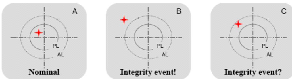
Il caso A è la situazione ottimale per la quale il sistema è disponibile e ricopre adeguatamente l'errore di posizione con entrambe le soglie.
