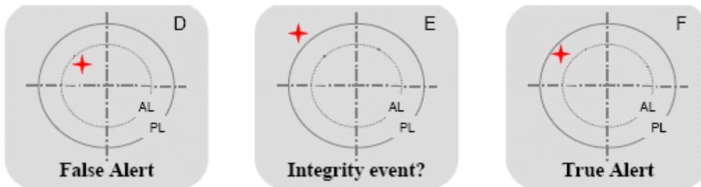
Nel caso D si ha un falso allarme in quanto il sistema viene dichiarato indisponibile ma l'errore di posizione è compreso all'interno di entrambe le soglie.
